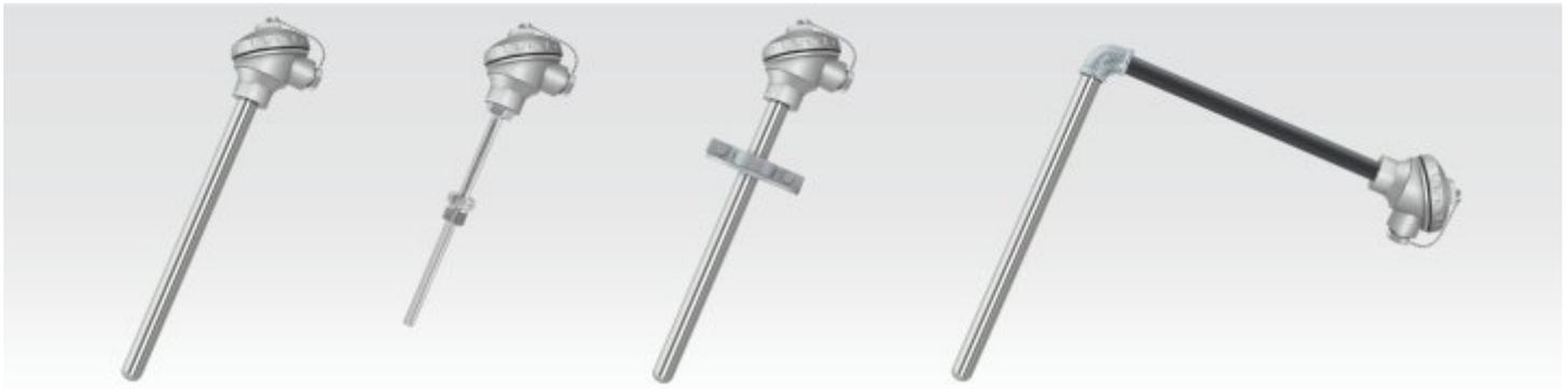
Termopares com tubos de proteção metálica possuem um custo relativamente baixo e são utilizados em medição em meio líquido e gases, em média e alta temperatura. Com o material da proteção adequado e dependendo das condições e da atmosfera do processo ou aplicação, podem ser utilizados até 1100°C.
