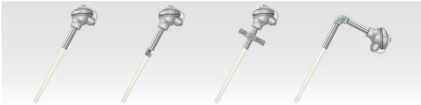
Estes termopares são normalmente utilizados em processos de alta temperatura em fornos na indústria cerâmica, vidreira, fundição e em locais onde não permitem a utilização de proteções metálicas devido a altas temperaturas ou ataques químicos ou algumas vezes em temperaturas mais baixas onde o meio ou a atmosfera do ambiente é prejudicial a tubos metálicos.
