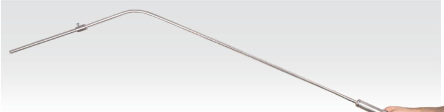
O termopar ALUK é um sensor de imersão para a medição da temperatura em metais líquidos não ferrosos, trata-se de um termopar tipo K, com proteção externa em aço cromo 446, usinada de uma barra, o que eleva a sua durabilidade e confiabilidade nas medições.
